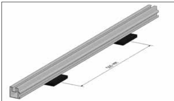
Balk midden hart op hart afstand 500 mm
